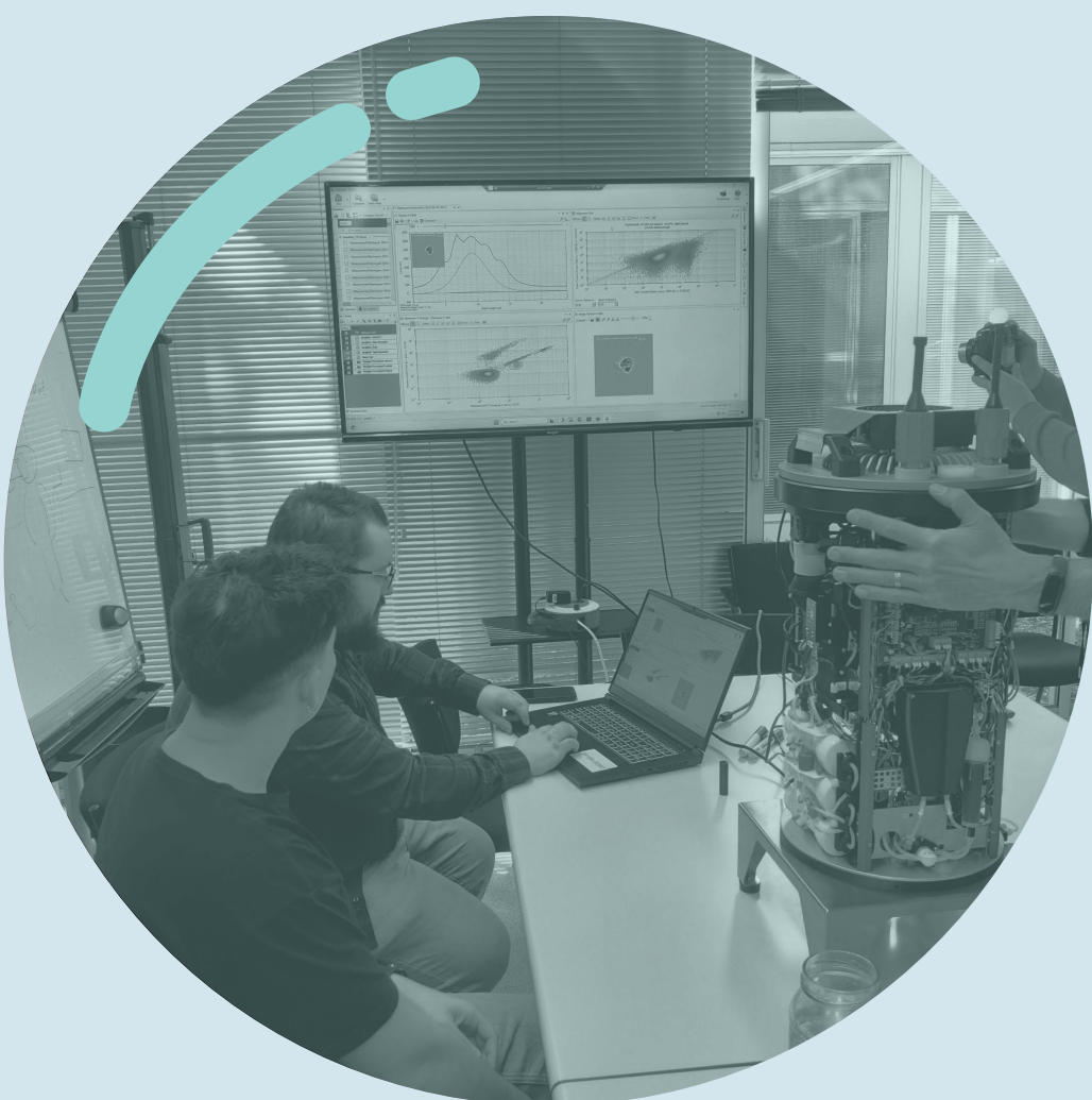
Уредът UVP6 след месеци подводен престой в обсерваторията OBSEA. Двете UV лампи предпазват оптичния прозорец и светлинния източник от биообрастване The UVP6 after months underwater at OBSEA. The two UV lights (small rounded tubes) protected the UVP6 viewport and light unit from fouling (Provided by Jean-Olivier IRISSON)
