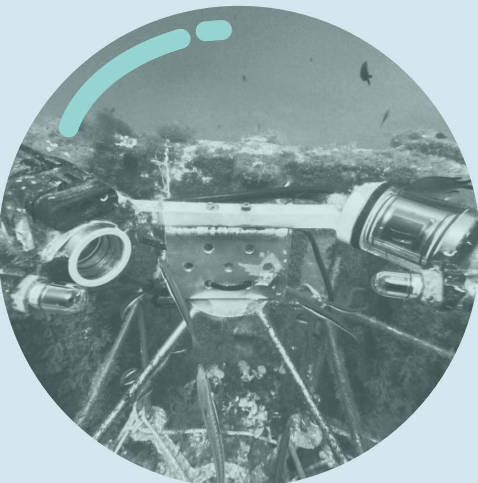
Уредът UVP6 след месеци подводен престой в обсерваторията OBSEA. Двете UV лампи предпазват оптичния прозорец и светлинния източник от биообрастване The UVP6 after months underwater at OBSEA. The two UV lights (small rounded tubes) protected the UVP6 viewport and light unit from fouling (Provided by Jean-Olivier IRISSON)
